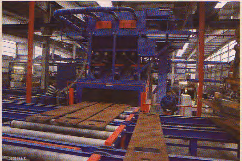
Die RRB 27/6 ist bei Bieber + Marburg für das Strahlen von kleinsten Stahlblechteilen bis hin zu Teilen mit einer Länge von bis zu 20 m im Einsatz.
