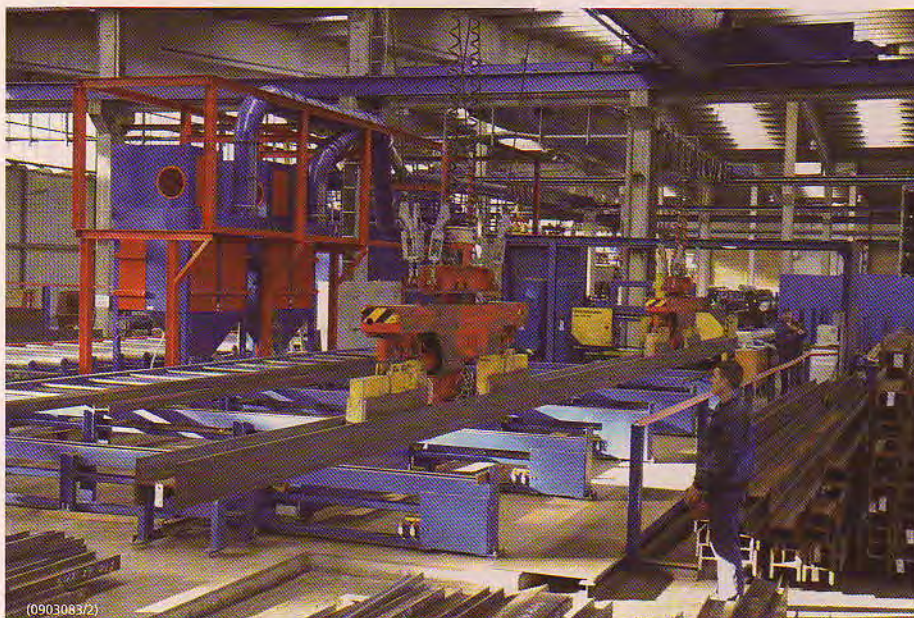
Insgesamt sechs Hochleistungs-Schleuderräder des Typs Hurricane H 42 mit 420 mm Durchmesser und einer Antriebsleistung von jeweils 22 kW sorgen für die hohe Strahlintensität. Der Reinheitswert SA 2,5 wird zuverlässig, reproduzierbar und wirtschaftlich erreicht (Fotos: Rösler Oberflächentechnik).
